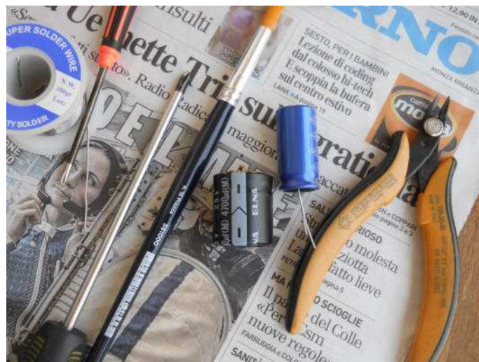
I vecchi elettrolitici appena smontati
