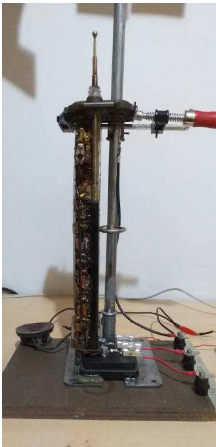
BC 611 montato sul supporto per riparazione e messa a punto della radio
