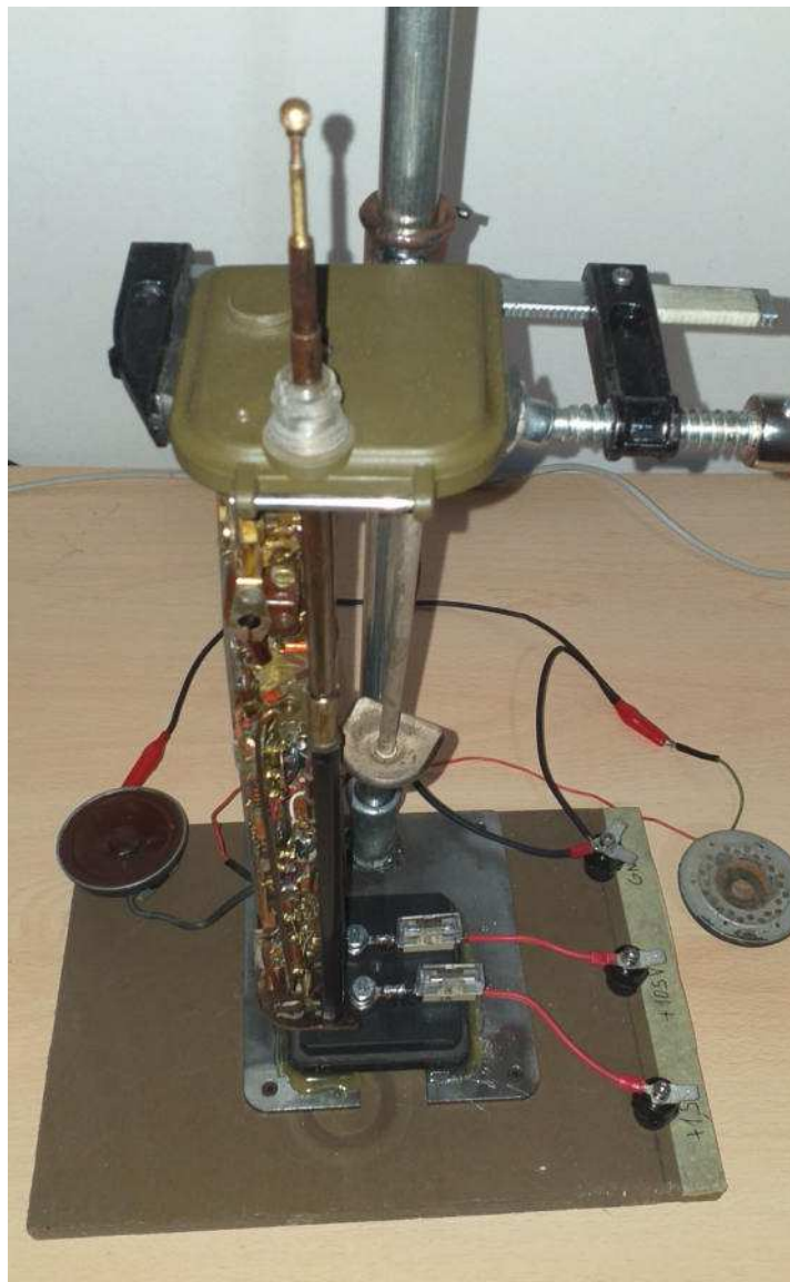
BC 611 montato sul supporto per riparazione e messa a punto della radio
