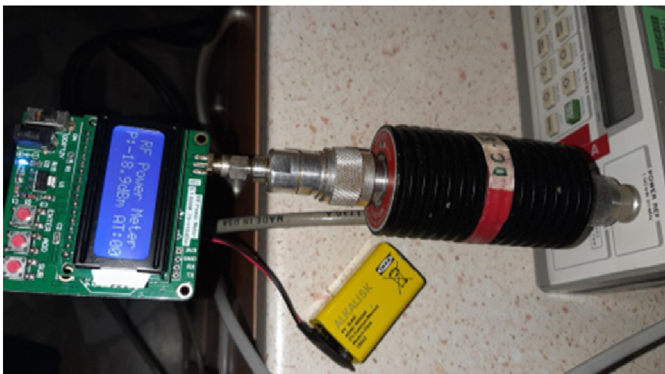
50 MHz 1 mW ref level con attenuatore da 20 dB fino a 6 GHz
