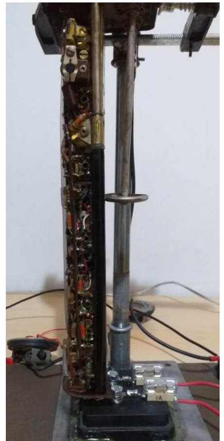
BC 611 montato sul supporto per riparazione e messa a punto della radio
