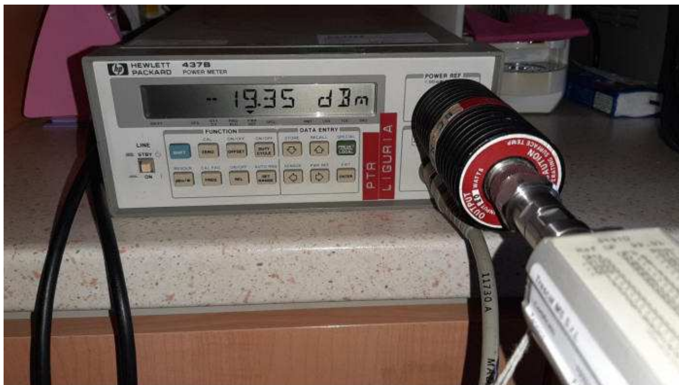
50 MHz 1 mW ref level con attenuatore da 20 dB fino a 6 GHz
