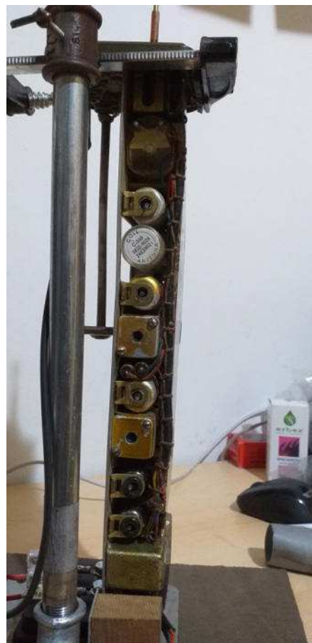
BC 611 montato sul supporto per riparazione e messa a punto della radio
