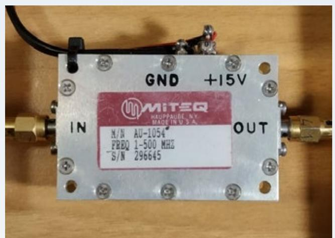
Figura 2: LNA Miteq, 30 dB di guadagno
