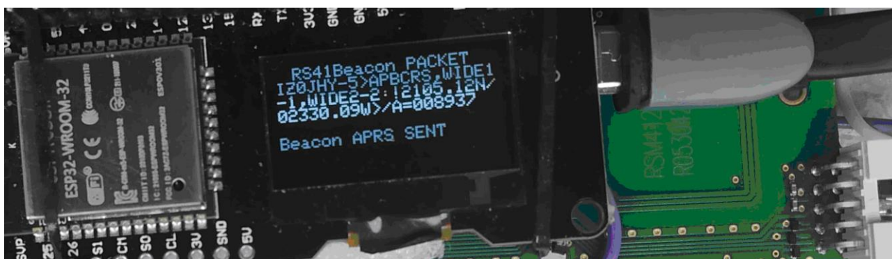
Figura 3: il controllore ESP32 collegato a wafer sulla scheda della sonda;
