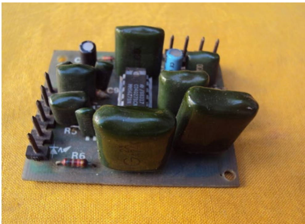
Piccolo decoder prodotto dalla GVH a circuito integrato
