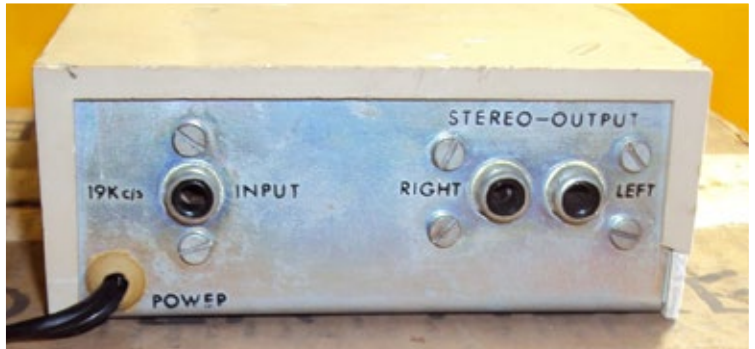
si riconoscono sulla destra le due uscite del segnale stereo
