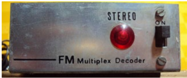
La spia accesa indicava la ricezione stereo Multiplex
