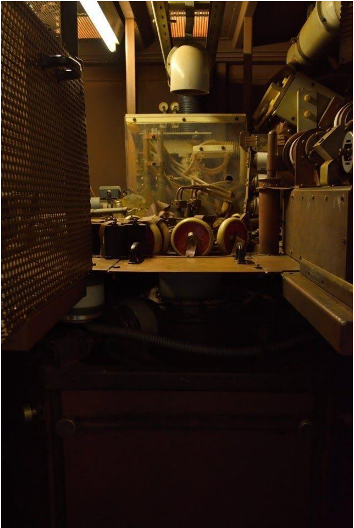
Immagine ravvicinata delle potenti valvole a onde corte della Brown Boveri & Cie.
