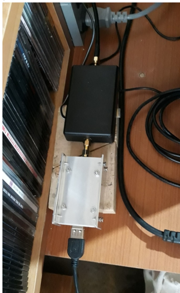
Figura 1: l'SDR e la scatola nera con all'interno l'amplificatore da 30 dB e il filtro passabanda;
