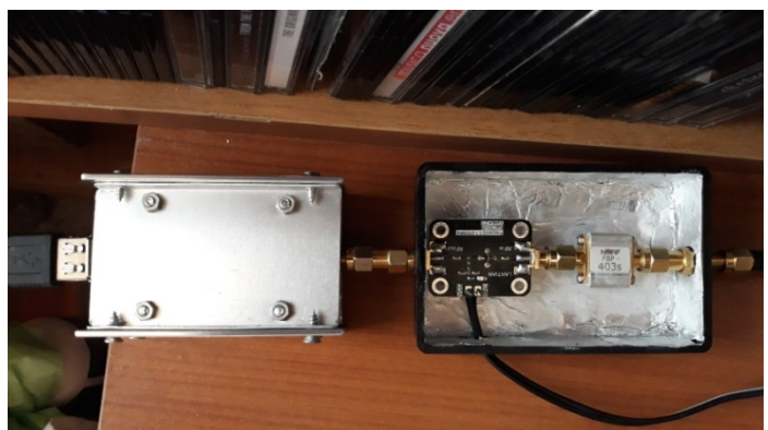
Figura 2: particolare dell'assemblaggio: SDR-filtro-preamplificatore;
