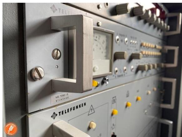
Nel corso degli anni lo staff tecnico di Radio Delta ha però deciso di acquistare un nuovo trasmettitore più moderno, optando per un Telefunken S2525 / 3 AM: un ottimo trasmettitore con un'ottima qualità audio. Questo trasmettitore di trasmissione HF è completamente allo stato solido fino all'amplificatore di potenza finale con 1 kilowatt di potenza in uscita continua, con copertura continua da 1,5 a 30 MHz.
