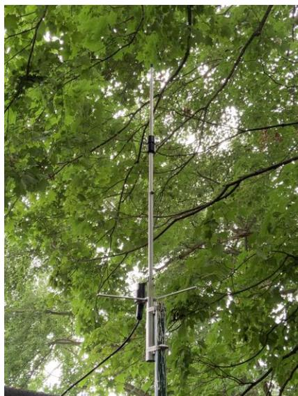
La Cushcraft AR-270 è essenzialmente una antenna verticale ground-plane per 2 metri e per i 70 centimetri. Di soli 122 cm di lunghezza, l'antenna AR-270 ha il radiatore che funziona come una 1/2 onda sui 2 metri; mentre grazie alla bobina alla base Alla base dell'antenna si trova una piccola bobina di carico e tre radiali da 17.1 cm ( vedi Foto 1 & 2 ). L'antenna pesa solo 900 grammi e sopporta 250 W su potenza su entrambe le bande.
