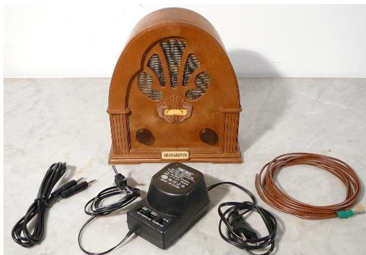
Il piccolo trasmettitore (100mW) emette su una frequenza AM il segnale ricevuto da una stazione in FM. Con questo sistema abbiamo mantenuto attiva la ricezione radio in scuole, mostre, case di appassionati.
