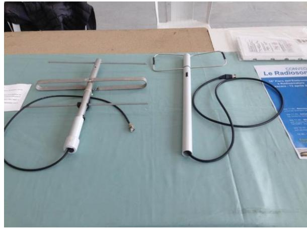
Figura 2: Yagi e MOXON portatili per ricerca in campo;
