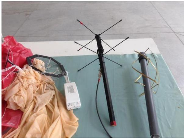
Figura 1: QFHA per radiosonde (a destra);
