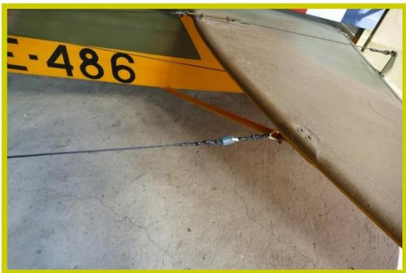
Foto N° 15 isolatore collegato al piano di coda
