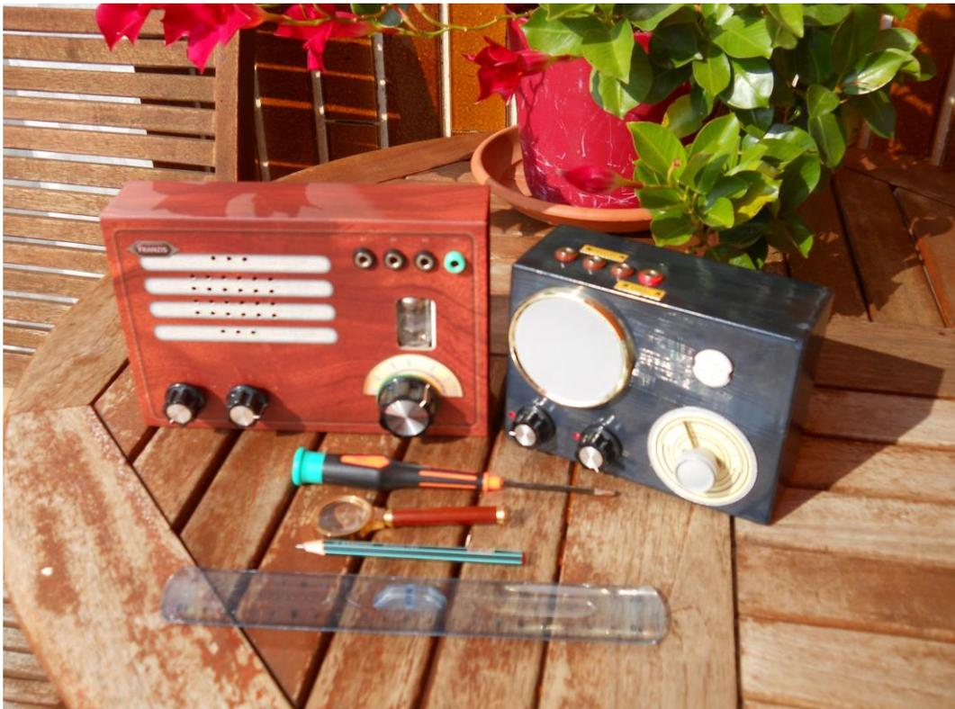
I Kit della "FRANZIS RADIO" sono noti per permettere ai "Novizi" di costruire RX a onde medie o corte, con Circuito a Reazione, con una valvola 6J1 (cinese) alimentata a bassa tensione a cui seguono alcuni transistor e un integrato per bassa frequenza con un mini altoparlante. Questi Kit sono istruttivi, ma va osservato che anche se appaiono semplici da costruire, per funzionar bene vanno montati con cura, pazienza e attenzione.
