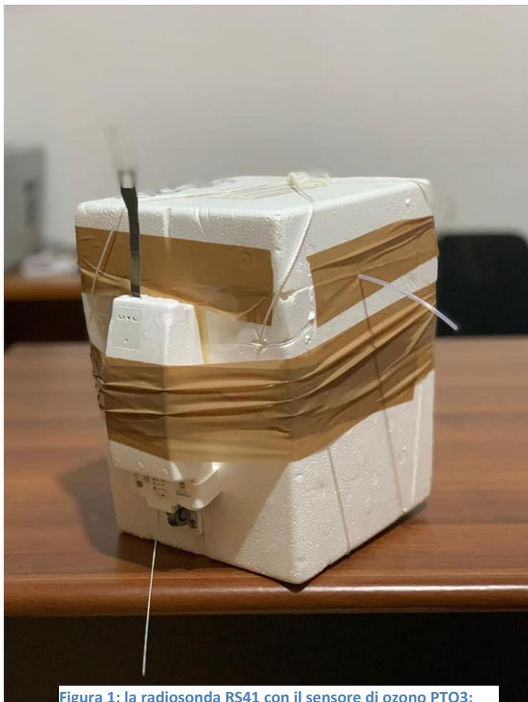
Figura 1: la radiosonda RS41 con il sensore di ozono PTO3;
