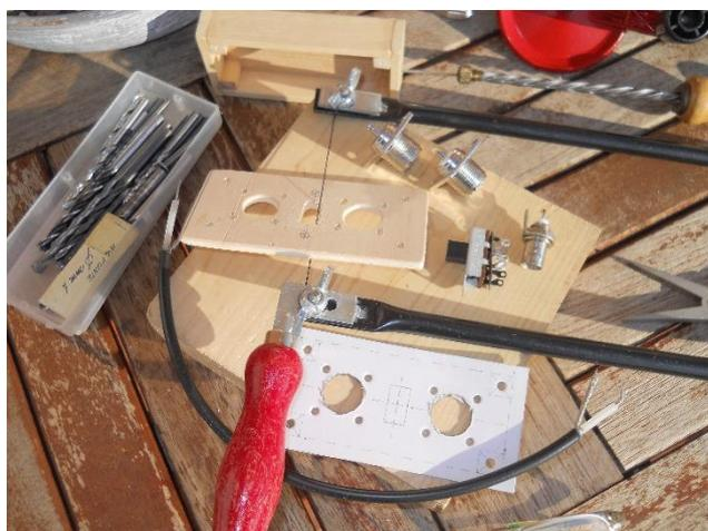
Come collante il Vinavil va benissimo, l'importante è lasciar asciugare il tutto bene e possibilmente disporre di morsetti da legno per serrare tutte le parti fino all'indurimento del collante; una volta essiccato, l'insieme diventa solido e robusto come un bel violino Stradivari!
