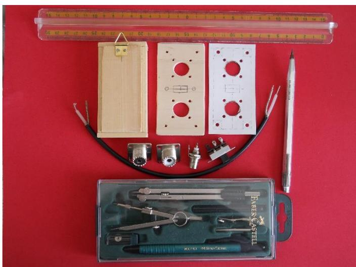
I pochi componenti necessari sono: n°3 connettori PL (quelli da baracchino CB per intenderci) un comune deviatore a slitta, n°14 viti da mm.3 di diametro, n°4 viti da legno ottonate, pochi centimetri quadri di buon legno compensato e un barattolino di ottima vernice grigia per aeromodelli, al tutto va aggiunto un po' di voglia di fare e una dose di olio di gomito... quest'ultimo oggi è merce che scarseggia e mi raccomando non andate a cercare di acquistarlo in Farmacia!
