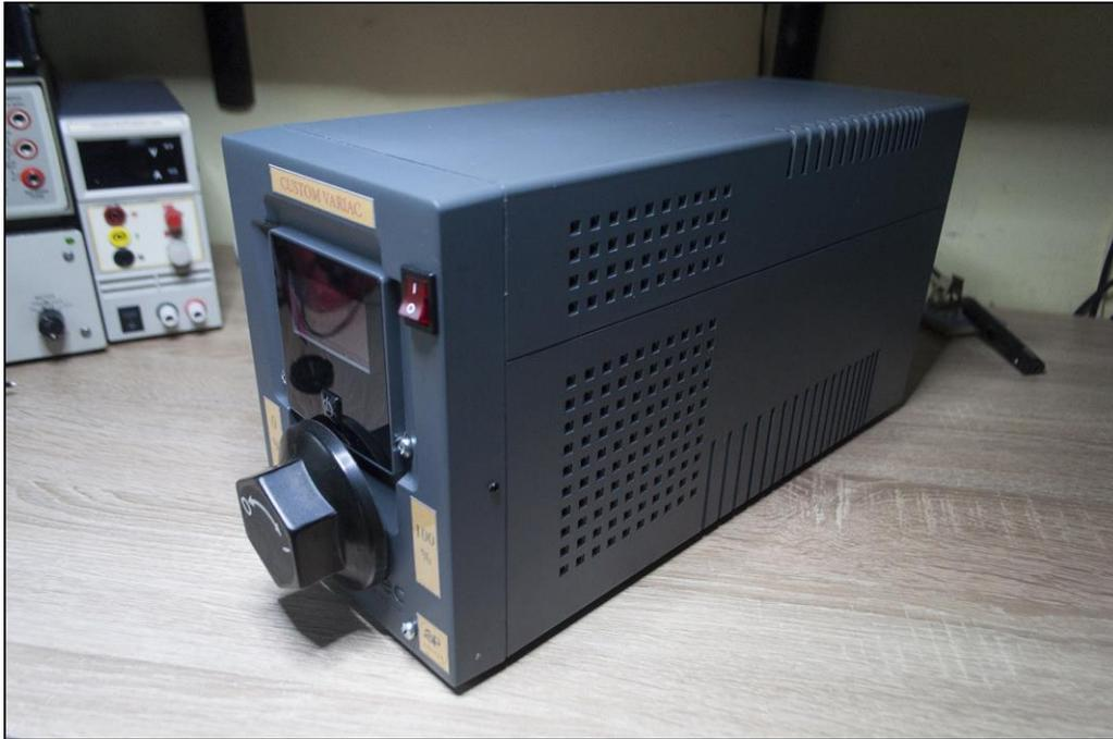
Il mio variac è stato costruito usando il contenitore di un UPS in disuso, in cui ho poi inserito un trasformatore di isolamento. Così ci separiamo dalla rete elettrica ENEL, in quanto molte radio d'epoca hanno il telaio collegato alla rete. A seguire, dopo il trasformatore c'è il variac o autotrasformatore variabile.
