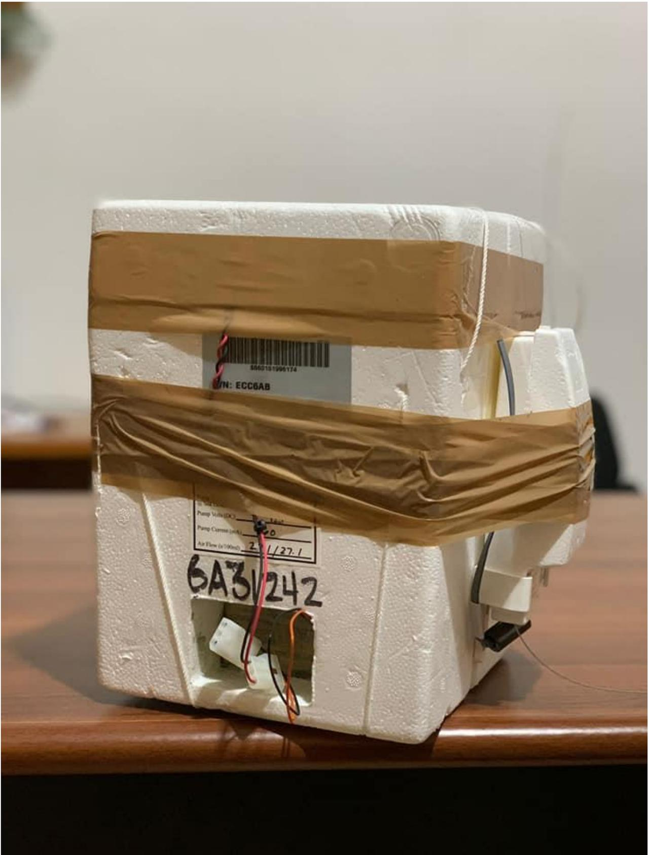
Figura 1: Radiosonda con sensore di Ozono;
