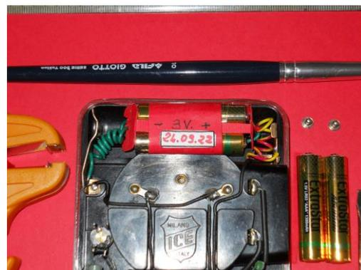
Per riportare al buon funzionamento il Supertester 680 C il problema era trovare una batteria nuova da 3 V delle stesse misure, l'ultima l'avevo cambiata nel 2012 ( ho l'abitudine di scriverci la data ) avevo montato una batteria cinese al manganese da 3V "Super Heavy Duty ALPHI", batteria che pur esaurita , per mia fortuna, non aveva fatto fuoriuscire il dannoso
