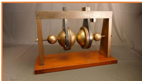
**Fotografia N° 4 Oscillatore tipo Righi a 4 sfere**
