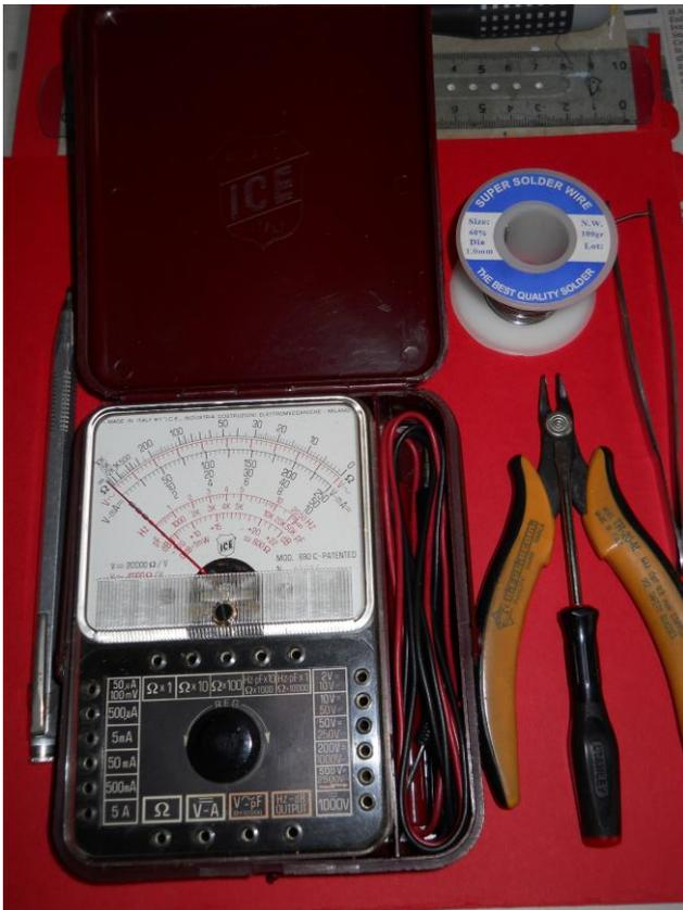
Elettronica il Supertester ICE 680 strumento analogico a bobina mobile a 20.00 Ohm/Volt ,10 campi di misura e 45 portate, il tutto in uno scafo di materiale plastico robusto e di ridotte dimensioni, circa cm.8,5 x 2,8 x 12,6 con soli 300 grammi di peso, dotato di custodia con 2 puntali, di color vinaccia e di una qualità costruttiva indistruttibile.
