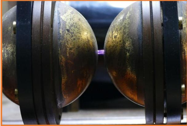
Il diametro delle sfere centrali determina la capacità del circuito oscillante, per cui sfere di grosso diametro significano alta capacità, quindi frequenza di oscillazione bassa e viceversa. Lo spazio tra queste sfere è il dielettrico del nostro condensatore per cui piccolo dielettrico alta capacità e viceversa.
