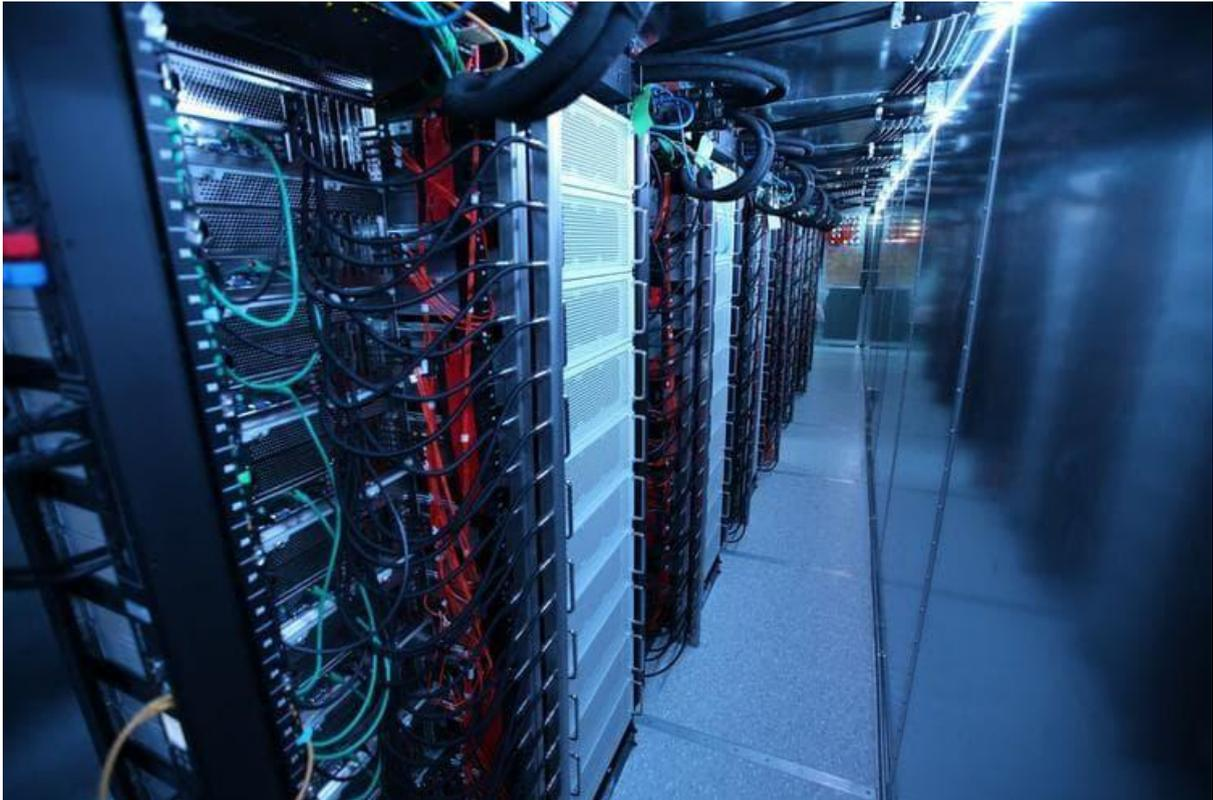
Il cosiddetto "Engine X", alloggiato in due container da 40 piedi, ciascuno contenente 128 nodi di calcolo in 15 rack delle dimensioni di un frigorifero. Ogni nodo è responsabile dell'elaborazione di 4 dei 1024 contenitori di frequenza raccogliendo la sua quota di segnali digitalizzati. (per gentile concessione CHIME)
