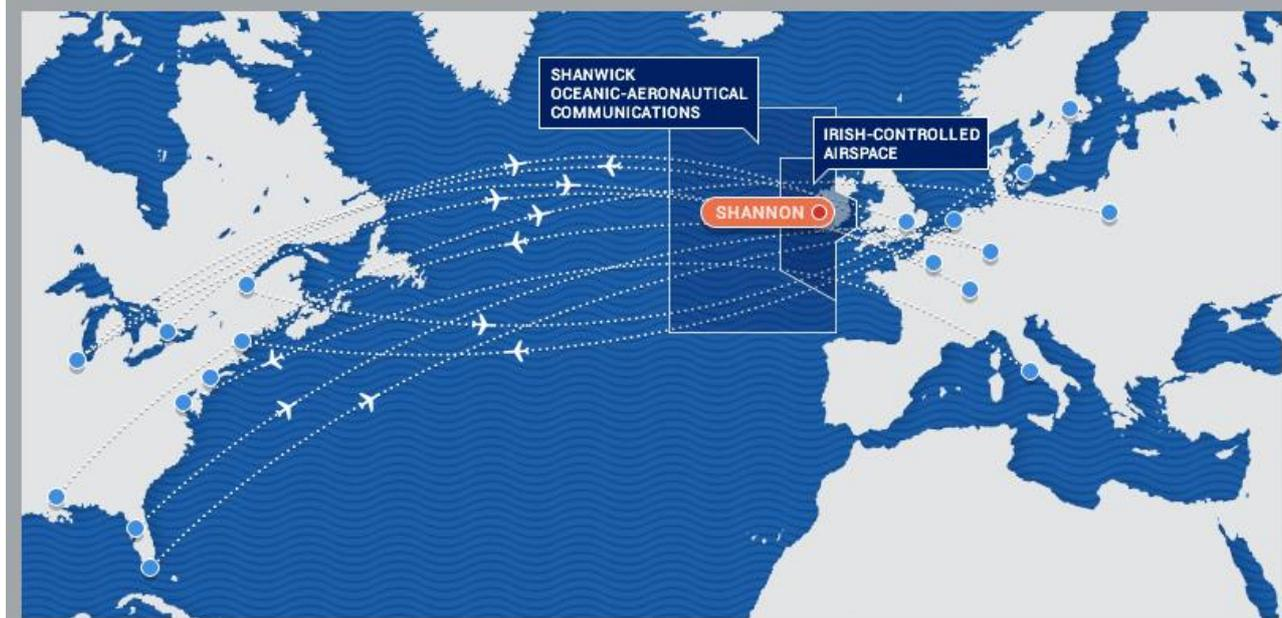
Oltre al Volmet c'è il servizio mobile aeronautico per Operazioni aria/terra **MWARA** (Major World Air Route Area). L'Irlandese Shanwick Radio con 20 canali di frequenza HF (e 2 VHF) fornisce un servizio di comunicazioni vocali a lungo raggio per il controllo del traffico aereo oceanico nella metà orientale dell'Atlantico settentrionale. Shanwick Radio si mantiene in contatto con tutti i voli nello Spazio Aereo Oceanico principalmente per mezzo di comunicazioni in HF.
