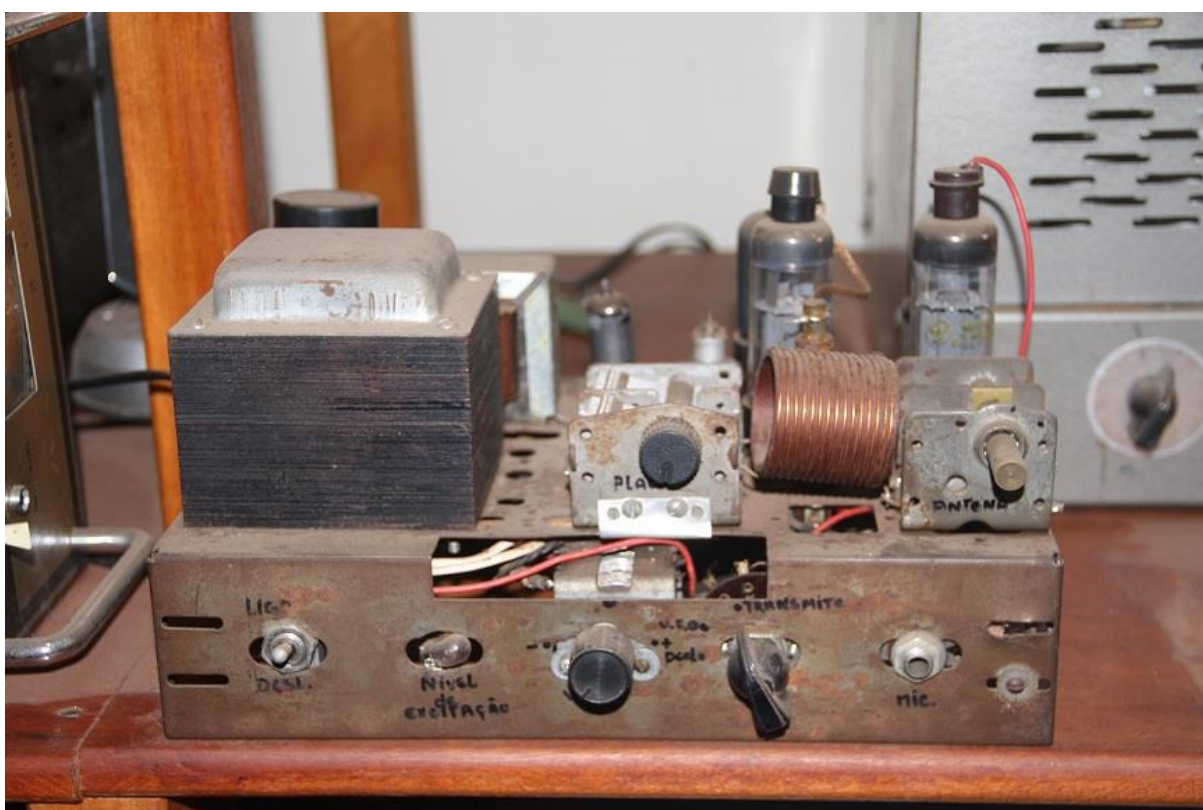
Forse uno dei più antichi trasmettitori della collezione, assemblato in Brasile, è un "homebrew", un termine gergale radioamatoriale per indicare apparecchiature radio non commerciali costruite in casa
